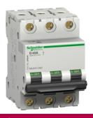
Multi9 - C60 UL1077 - MCB - 3P - 20 A - C Curve - 480Y/277 V - 5 kA
